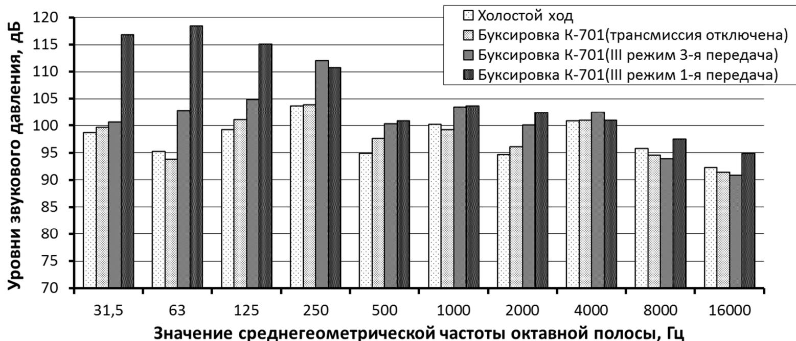
Рисунок 81 – Октавный спектр внешнего шума при использовании полой трубы
