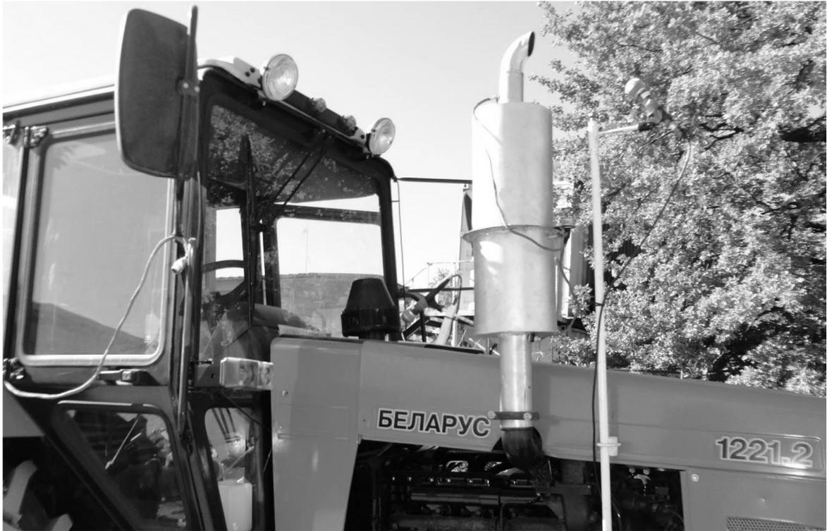
Рисунок 33 – ГШАТ, установленный на трактор «Беларус – 1221»
