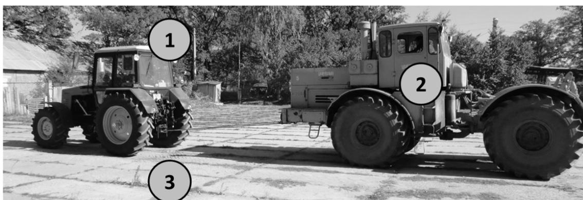
1 – объект испытаний; 2 – грузозачерпывающее устройство; 3 – плиты поверхности
