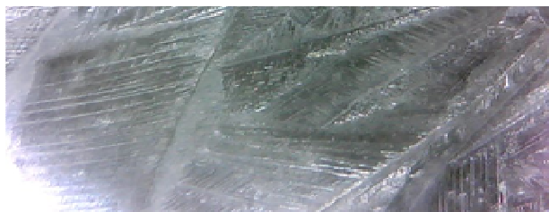
Рисунок 1 – Кристаллы карбамида ( K_{ув} = 110 раз)
