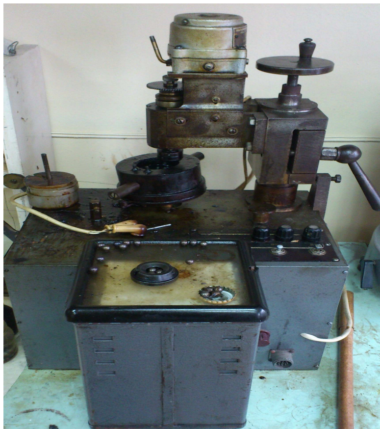
Рисунок 3.8 – Общий вид четырехшариковой машины трения и схема для оценки смазывающих свойств топлива
