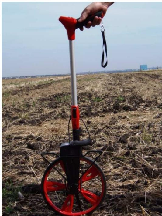
Рисунок 3.4 - Электронное дорожное измерительное колесо (курвиметр) ADA Wheel 100 Digital
