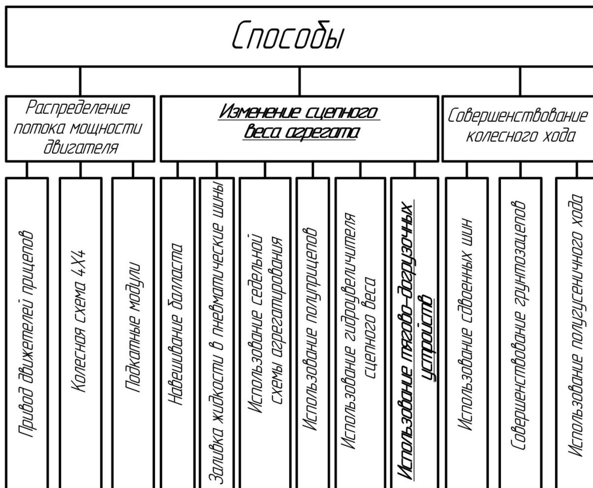
Рисунок 1.1 - Классификация способов улучшения тягово-сцепных свойств колесных тракторов
