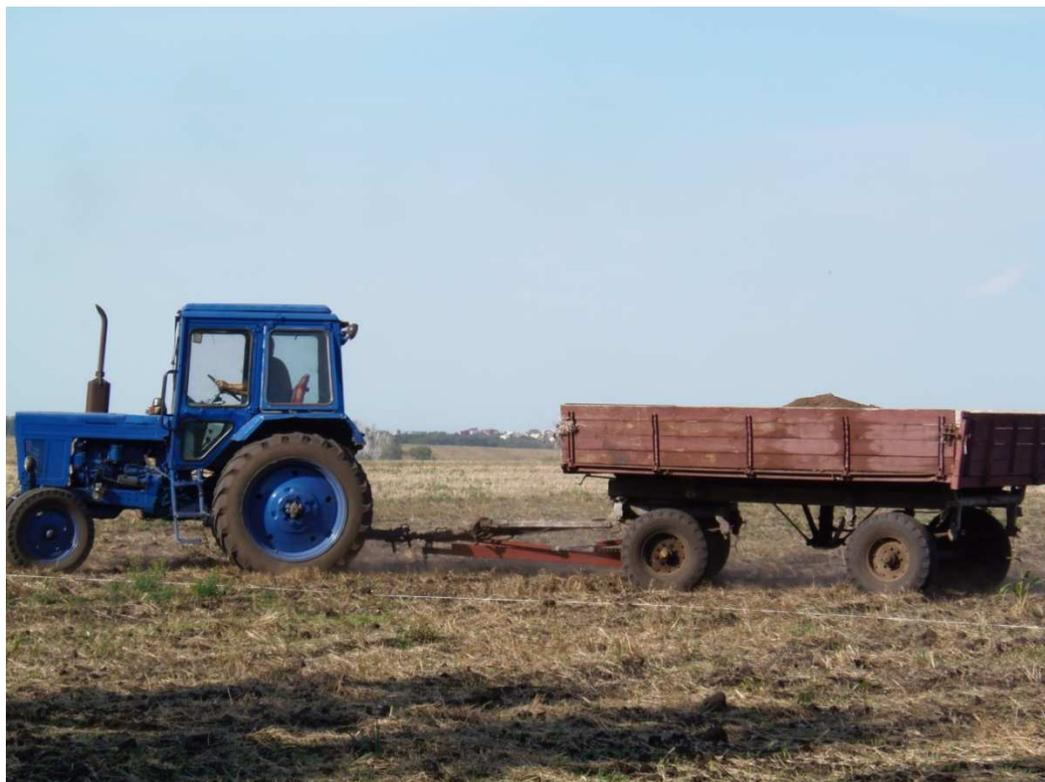
Рисунок 3.3 – Прицепной ТГА в составе МТЗ-80+2ПТС-4
