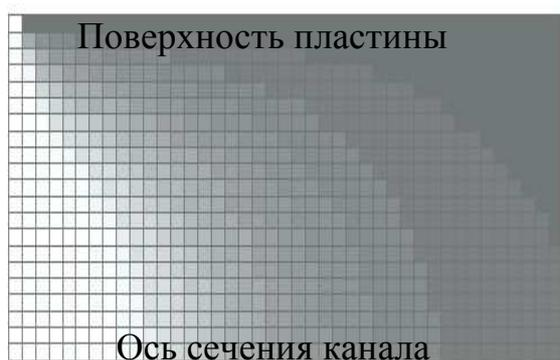
Рисунок 4. Поле температур в половине сечения канала
