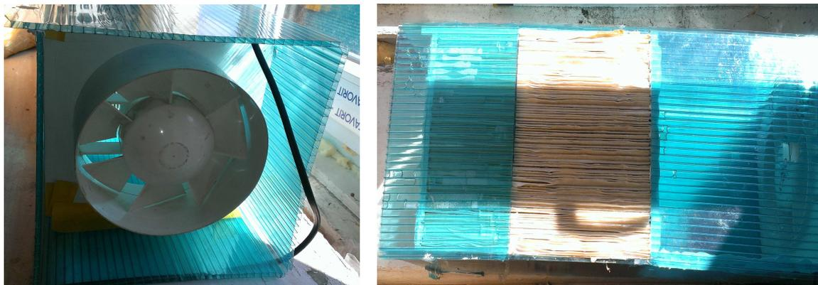
Рисунок 11. Лабораторные образцы водоиспарительных охладителей воздуха.
