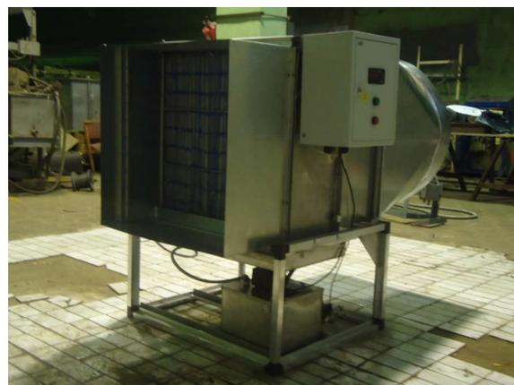
Рисунок 22. Водоиспарительный пластинчатый охладитель воздуха (охладительный блок)
