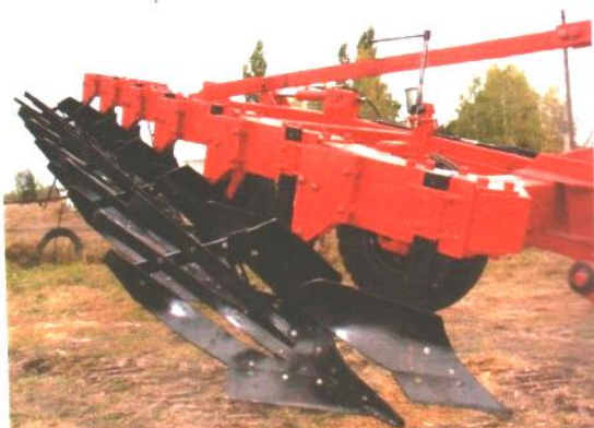
Рисунок 1.44 – Энергосберегающий полосовой плуг с вибраторами ПН-6-45 Воронежского аграрного университета и предприятия «Аква-Свар» [22]
