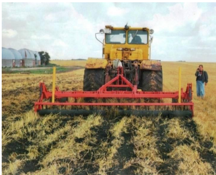
Рисунок 4.7— Комбинированный агрегат с циклоидальными стойками Грязинского культиваторного завода при испытаниях на проходимость по стерневому фону в ОПХ института рапса Липецкого района Липецкой области (промышленный образец)
