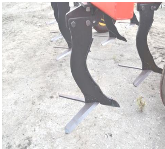
Рисунок 4.16 — Самоочищающиеся лапы, установленные за энергосберегающими стойками
