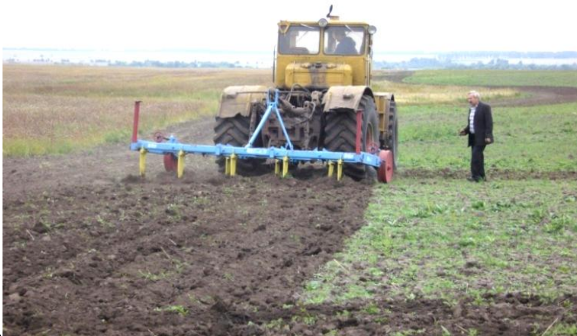
Рисунок 4.3 — Хозяйственные испытания энергосберегающего безотвального штангового культиватора с циклоидальными стойками по дискованному полю бороной БДМ-6 в фермерском хозяйстве «Прогресс» Коньшевского района Курской области.
