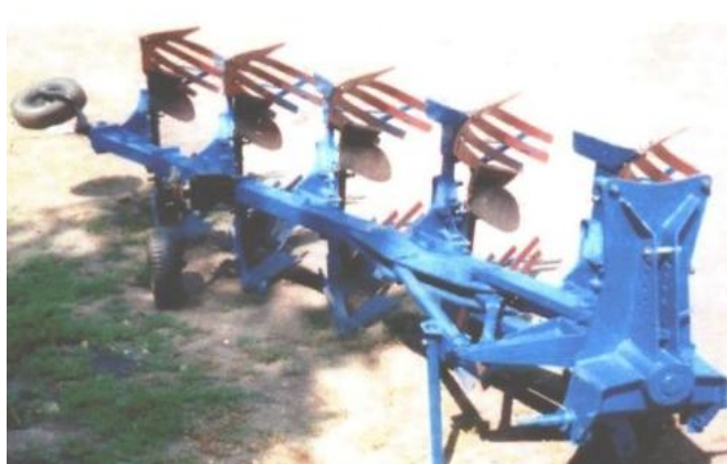
Рисунок 1.45.-Навесной оборотный энергосберегающий плуг с полосовыми отвалами ПОН-5-45 Воронежского аграрного университета [22]
