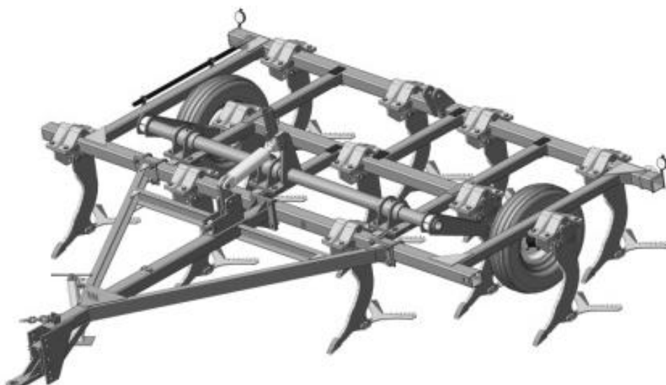
Рисунок 3.1 – Культиватор тяжелый модернизированный КТ- 3,9 МП/МН с циклоидальными стойками (промышленный образец)
