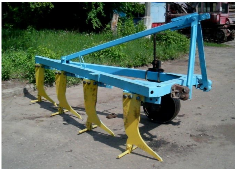
Рисунок 3.3 – Циклоидальные штанговые стойки на раме серийного отвального плуга ПН-4-35
