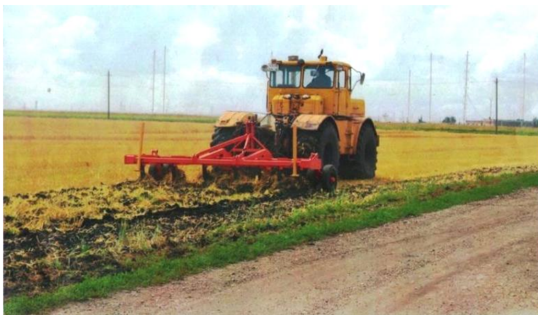
Рисунок 4.6 — Комбинированный агрегат с циклоидальными стойками на испытаниях по определению минимальной и средней глубины обработки почвы по стерневому фону в ОПХ института рапса Липецкого района Липецкой области (промышленный образец)
