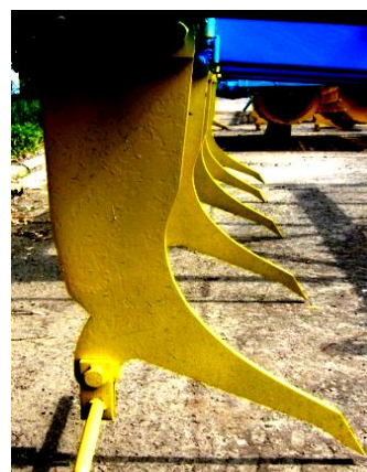
Рисунок 1.39 - Агрегат с циклоидальной стойкой и прямой рифленой шарнирной штангой нашей конструкции
