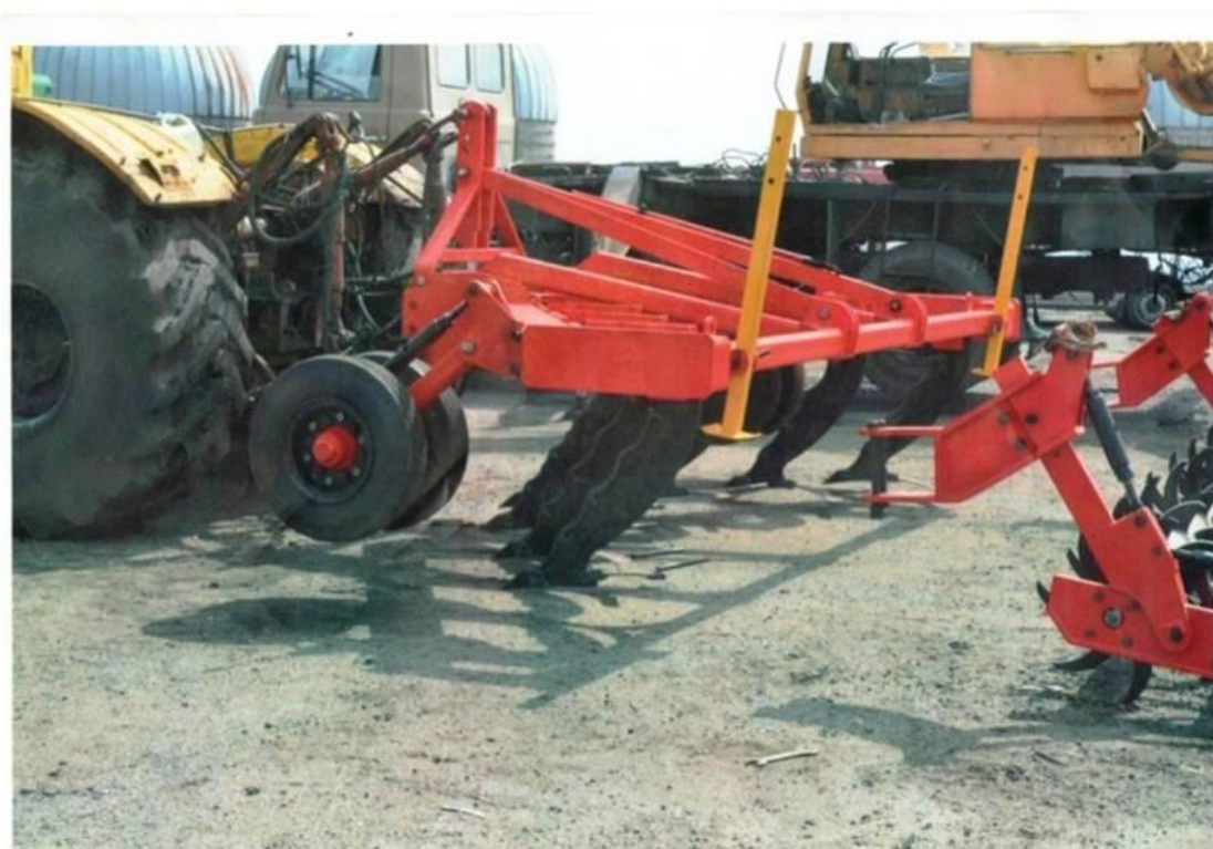
Рисунок 3.5. — Циклоида́льный глубоко́рыхлитель с циклоида́льным ротором (промышленный образец)
