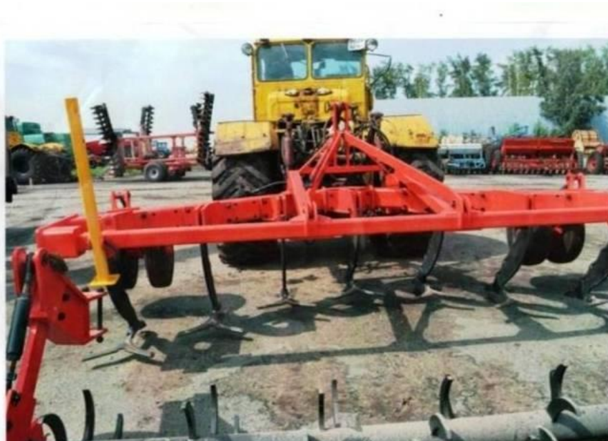
Рисунок 3.6 — Циклоидальный глубокорыхлитель, вид сзади (промышленный образец)
