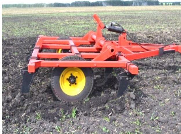
Рисунок 4.16 — Самоочищающиеся лапы, установленные за энергосберегающими стойками
