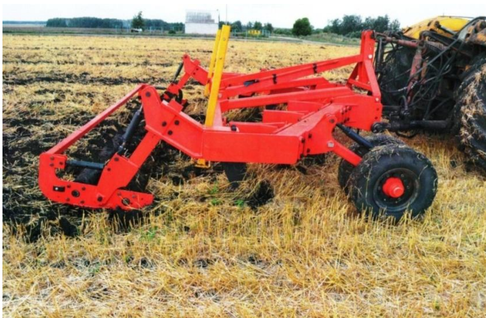
Рисунок 4.5 — Комбинированный агрегат с циклоидальными стойками Грязинского культиваторного завода на испытаниях по определению максимальной глубины обработки почвы по стерневому фону в ОПХ института рапса Липецкого района Липецкой области (промышленный образец)
