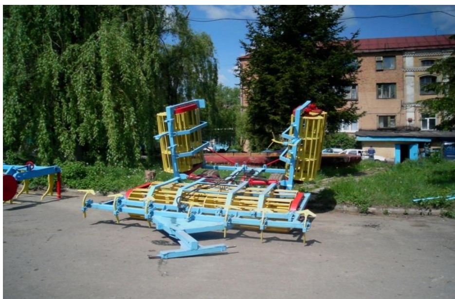
Рисунок 3.4 — Экспериментальный почвообрабатывающий агрегат, ротационный комбинированный ПАРК-6
