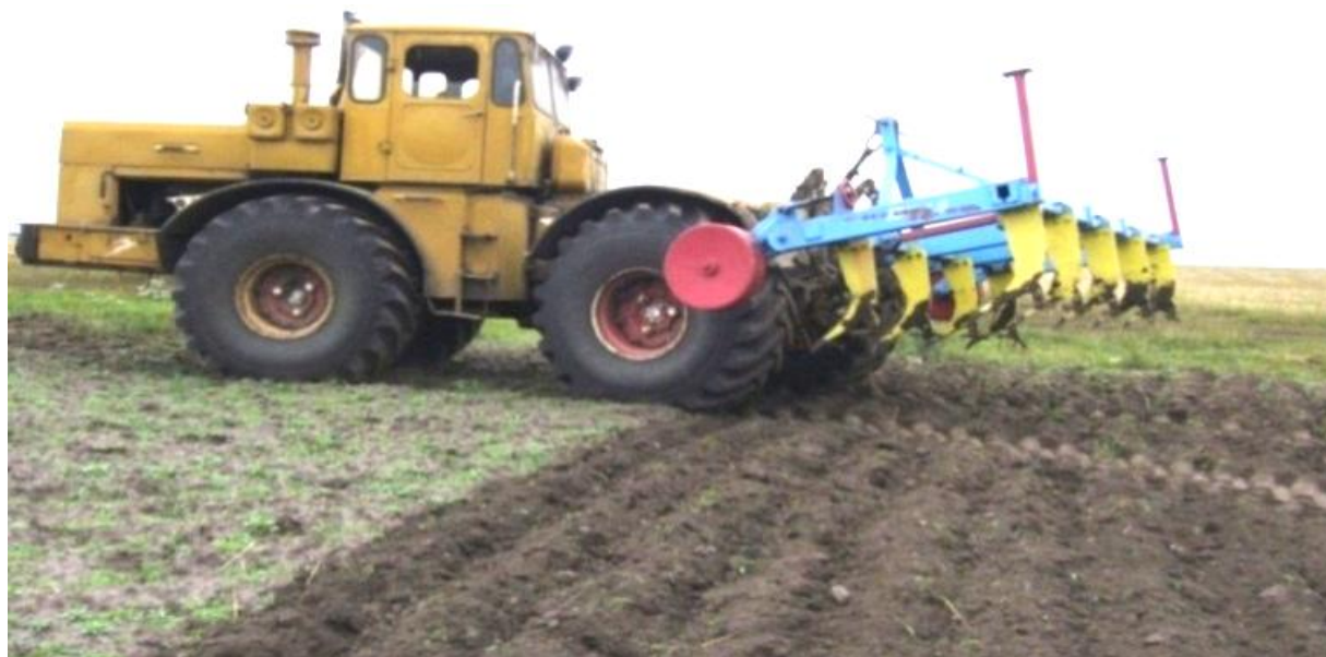
Рисунок 4.4 — Испытания циклоидального штангового культиватора в хозяйстве «Прогресс» Коньшевского района Курской области
