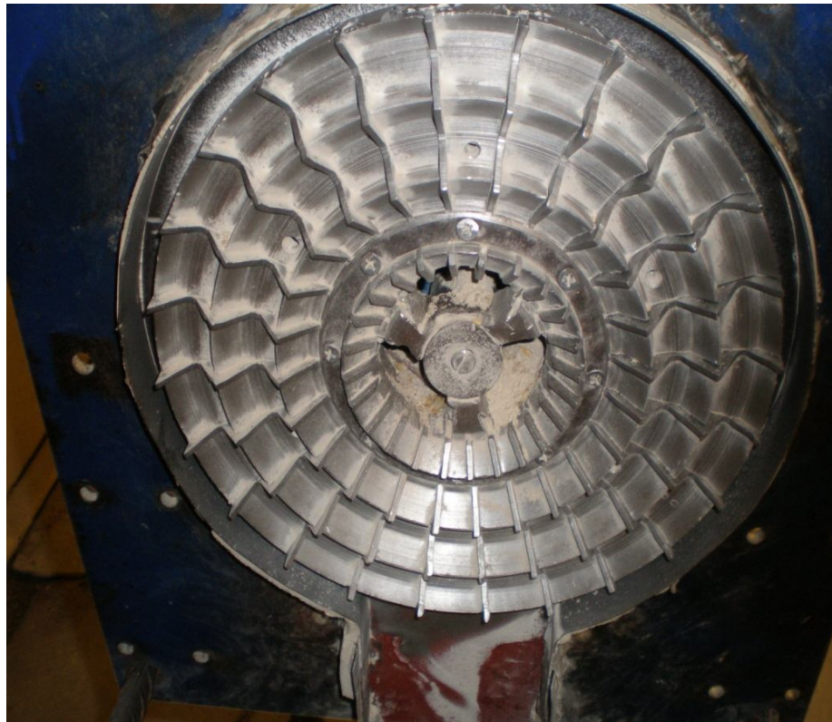
Рисунок 3.5 – Правая половина УЦИ с загрузочными окнами
