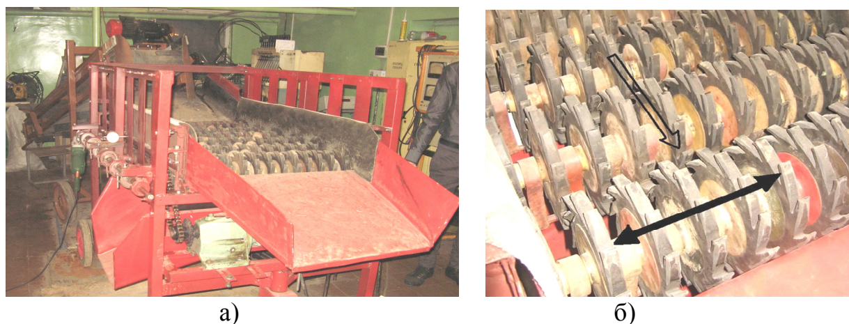
Рисунок 9 – Экспериментальный образец виброротационной сортировки (а) и сортирующая поверхность (б)
