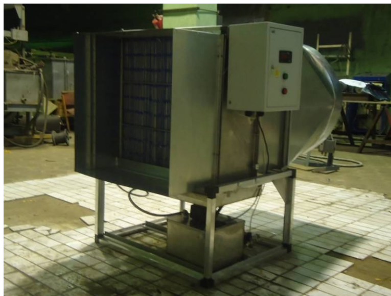
Рисунок 5.10 Водоиспарительный пластинчатый охладитель воздуха (охладительный блок)
