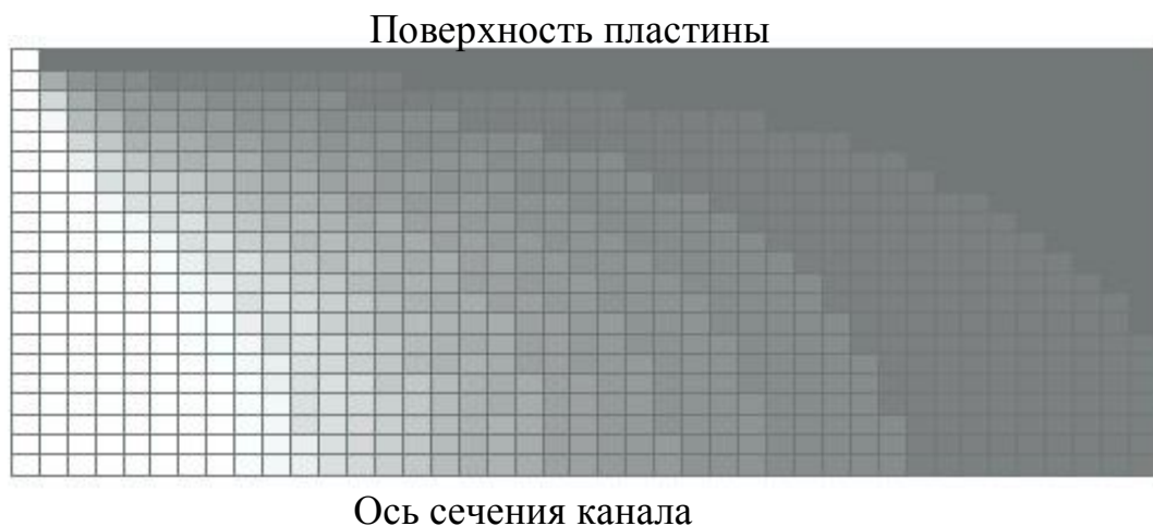
Рисунок 3.3. Поле температур в половине сечения канала
