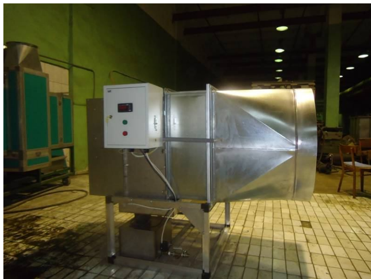
Рисунок 5.9 Водоиспарительный пластинчатый охладитель воздуха (охладительный блок)
