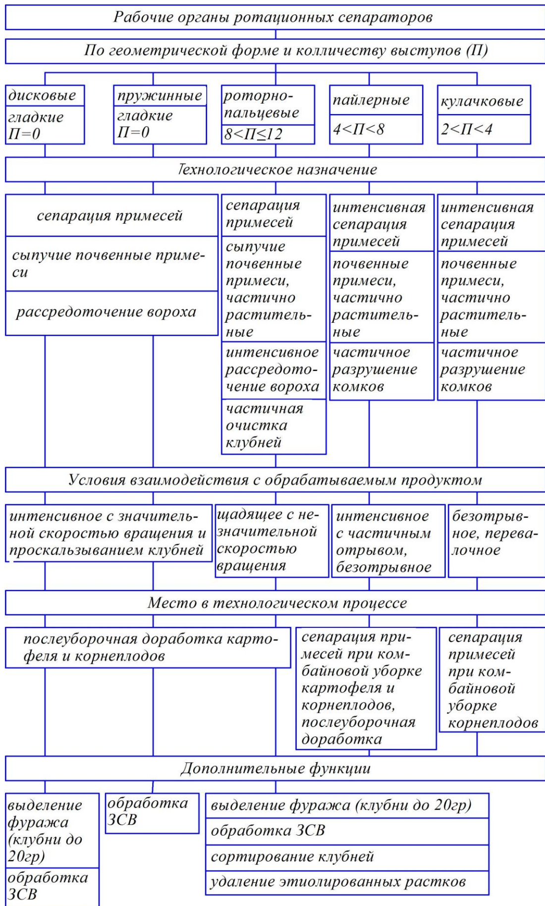
Рисунок 1.1 – Классификация рабочих органов ротационных сепараторов
