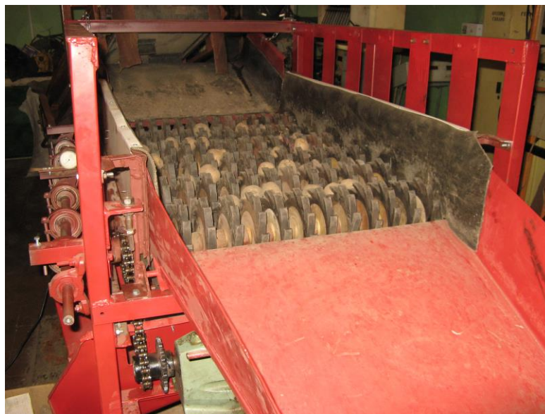
Рисунок 3.4 – Общий вид экспериментальной виброротационной сортировки
