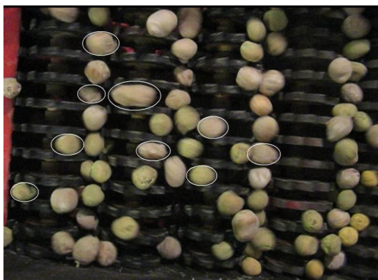
Рисунок 4.5 – Ориентирование клубней вследствие вибрации
