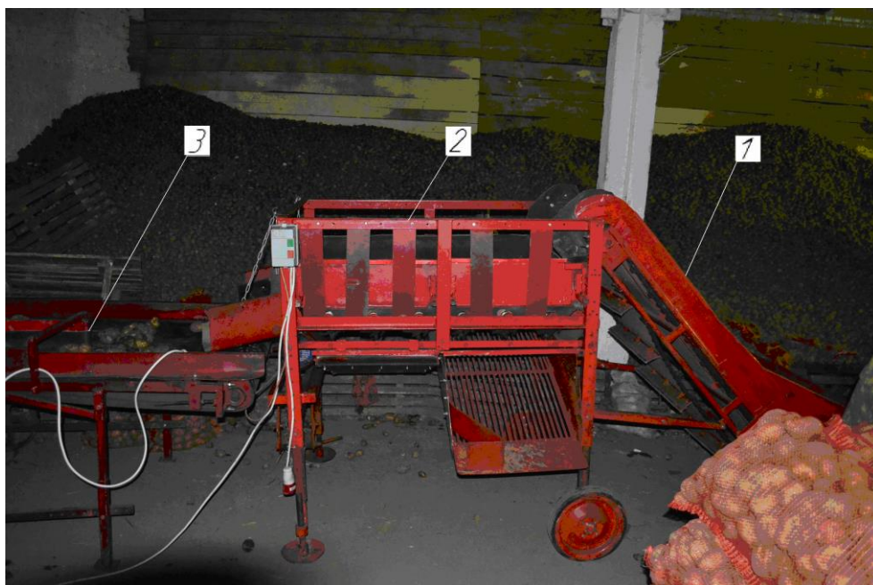
1 – подающий конвейер; 2 – виброротационная сортировка; 3 – инспекционный стол
